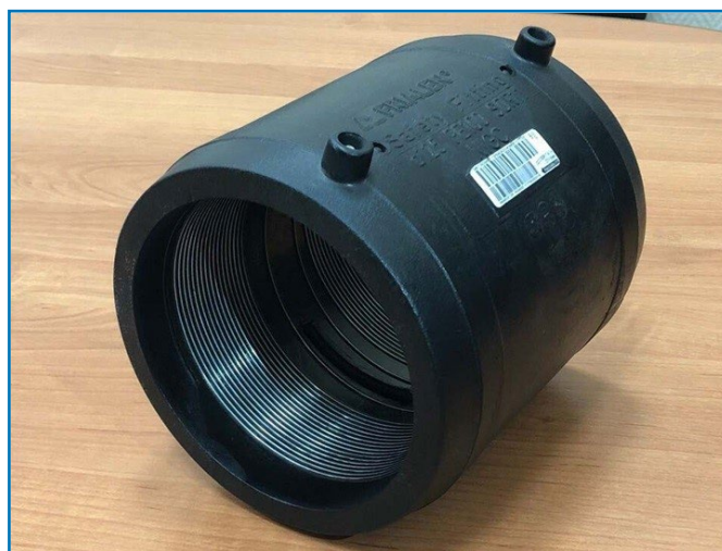
Рисунок 2. Муфта традиционной конструкции с проволочным закладным нагревательным элементом спиральной формы для терморезисторной сварки труб из термопластов.
