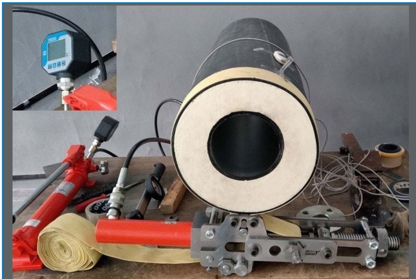
Рисунок 10. Гидравлическое устройство для создания необходимого давления обжатия муфты.
