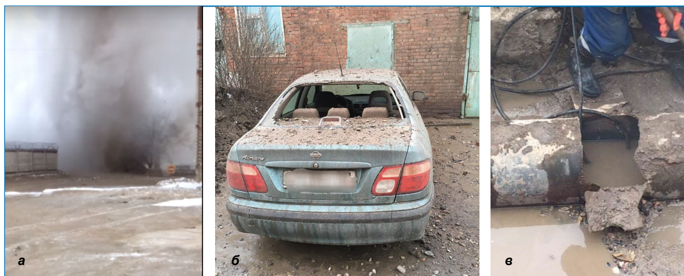
Рисунок 1. Момент (а) и последствия взрыва пара в Смоленске (б). Разрыв паропровода, обнаруженный при вскрытии трассы (в)..
